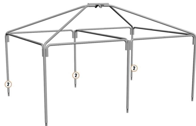
**6. Соедините основание и верхнюю часть каркаса, установив свободный торец поз. 2 в вертикальный стакан поз. 1 и поз. 4, соответственно**
